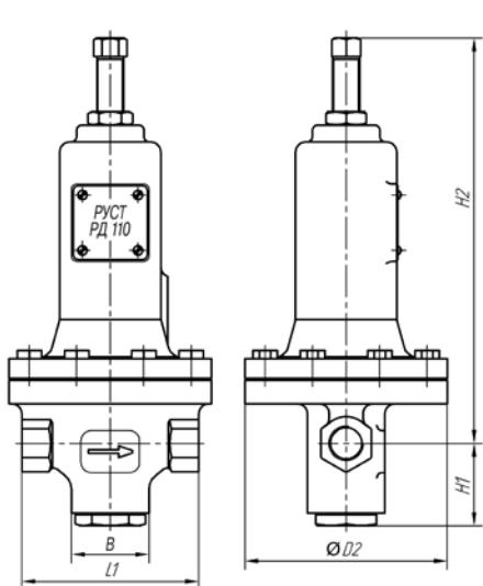
Рис. 48. Габаритные размеры регулятора давления РД 100 муфтового исполнения
