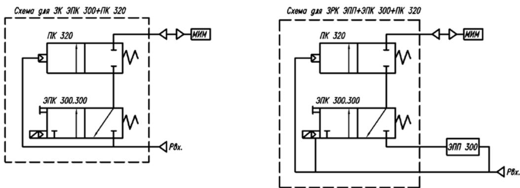
Рис. 61. Габариты и пневмосхема ПК 320
