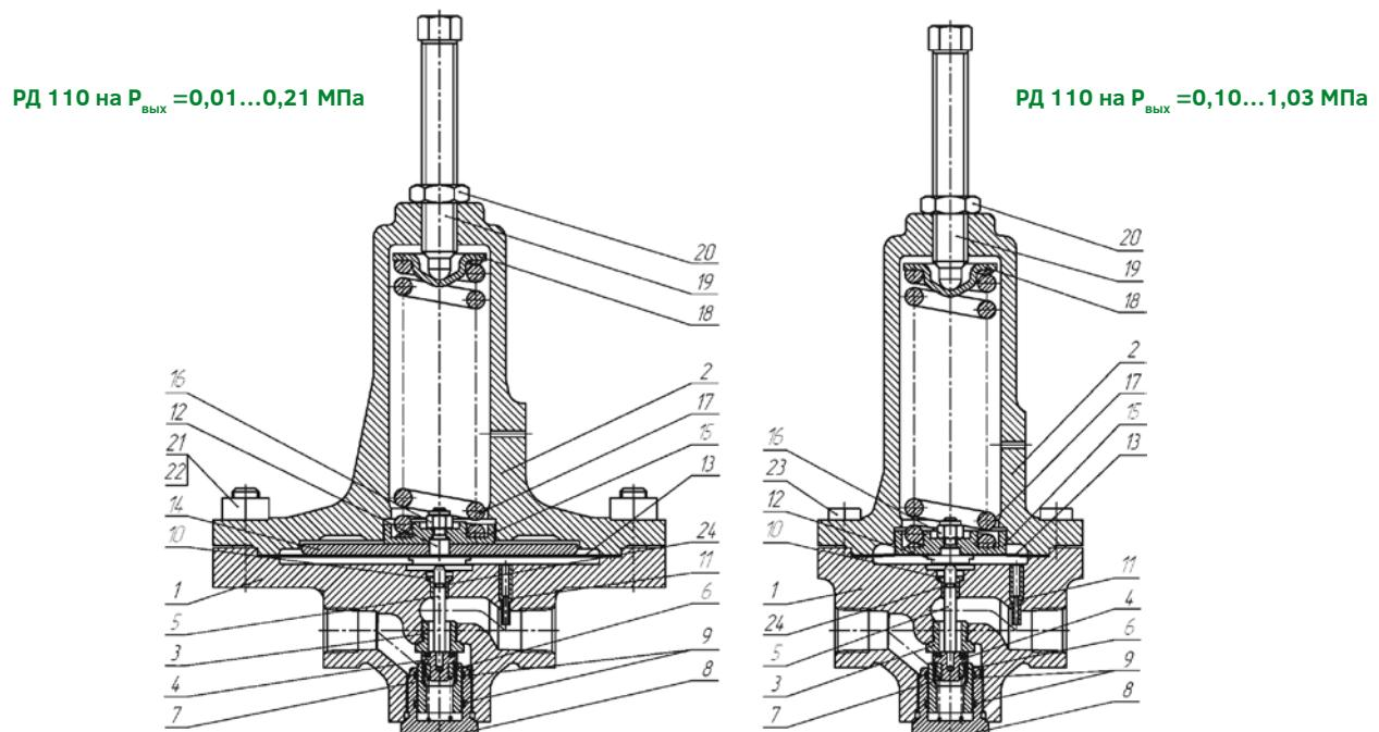
Рис.46. Конструкция регулятора давления РД 110
