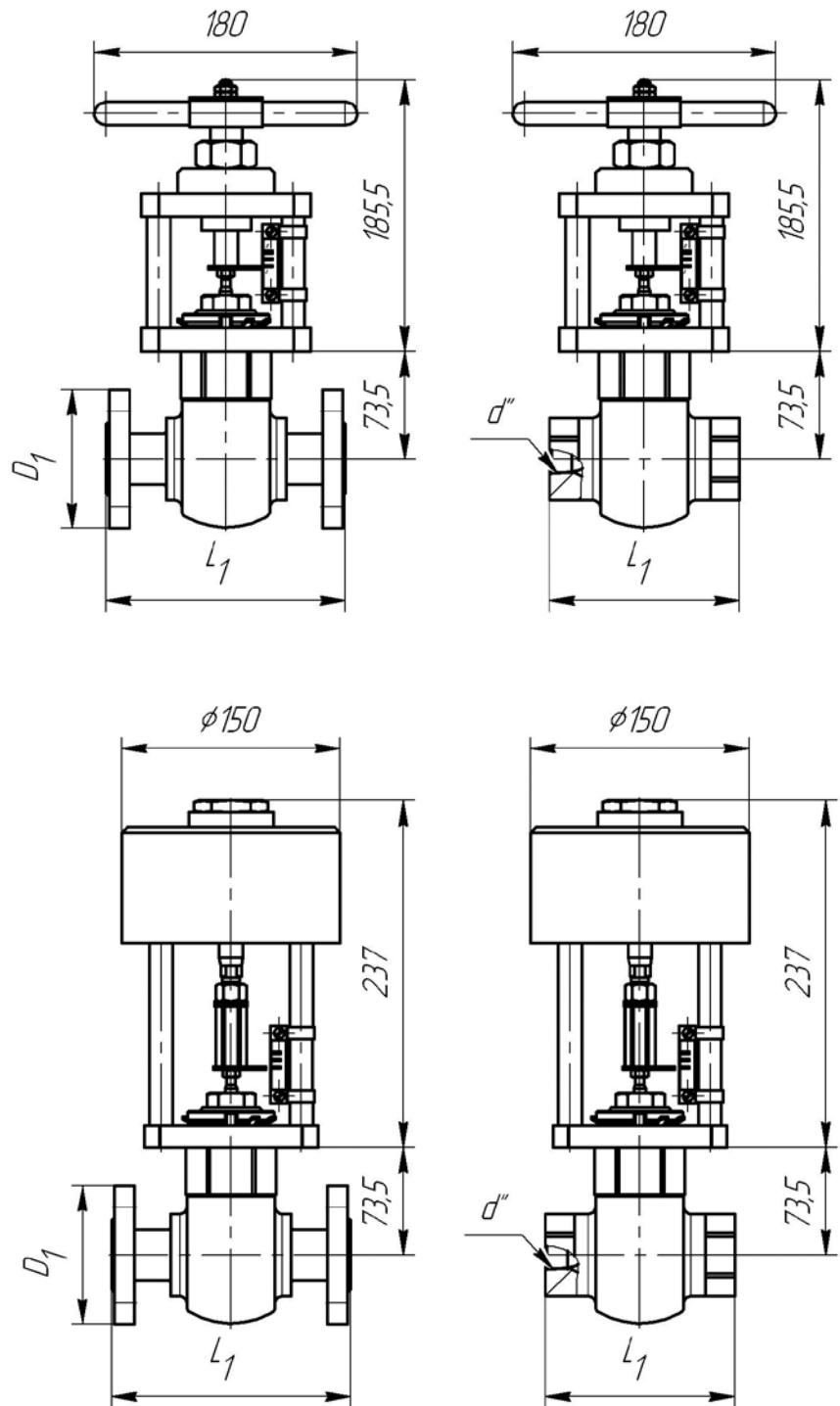
Рис. 20. Габаритные размеры клапанов микрорасхода РУСТ серии 411
