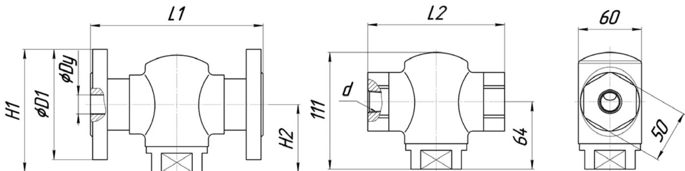
Рис. 55. Габаритные и присоединительные размеры фильтров сетчатых Т-образного типа серии ФС
