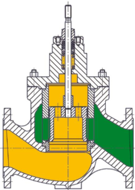
Рис. 4. Исполнения основного уплотнения клапанов РУСТ® серий 300, 400, 500
