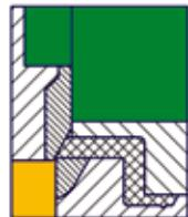
Металлические поверхности выполняются из твердых и эрозионностойких материалов, в т.ч. с применением наплавки стеллита и других спецсплавов.
