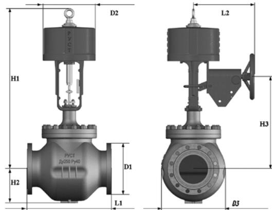
Рис. 13. Габаритные и присоединительные размеры клапанов РУСТ® серий 300, 400, 500 с электроприводом AUMA
