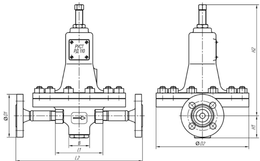
Рис. 49. Габаритные размеры регулятора давления РД 100 фланцевого исполнения
