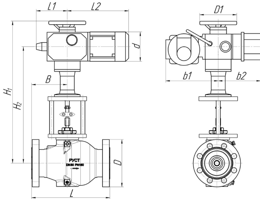
Рис. 42. Габаритные и присоединительные размеры клапанов осевых
