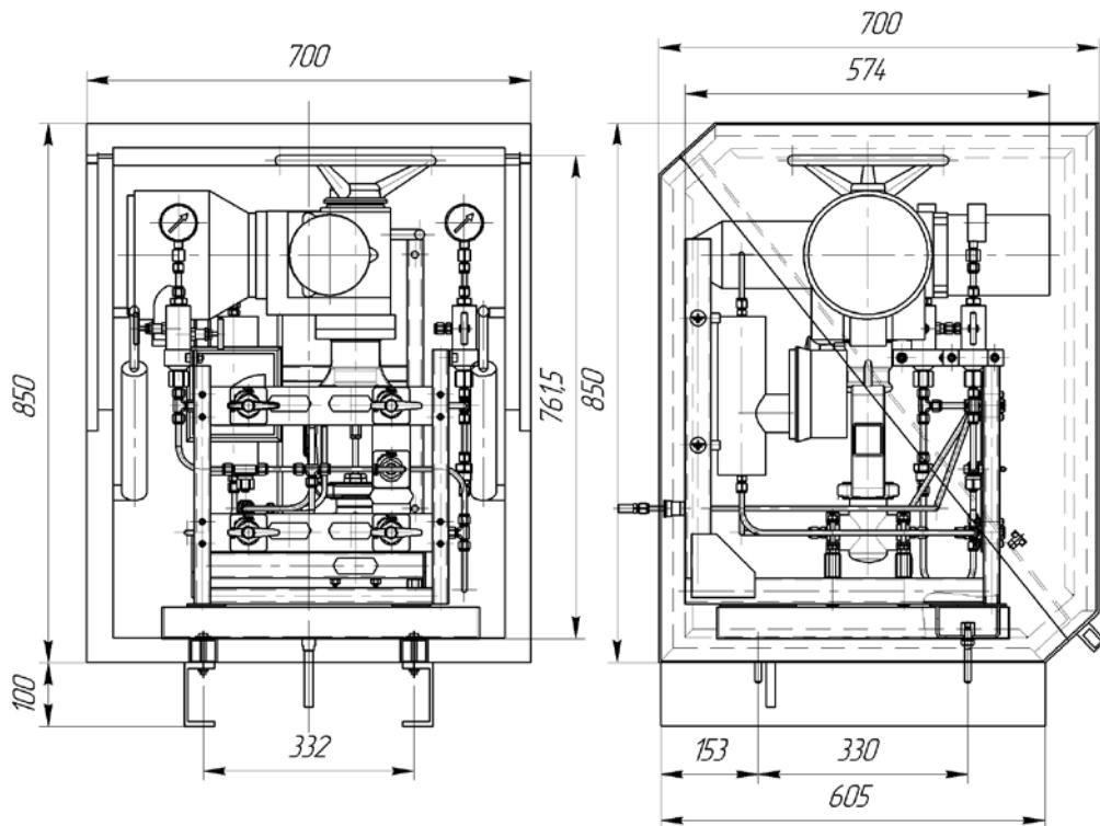
Рис. 73. Модульная СРПИ серии РУСТ® 250, 300
