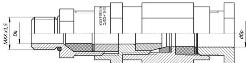
Г) Кабельный ввод ВКВ 070 для монтажа бронированного кабеля
