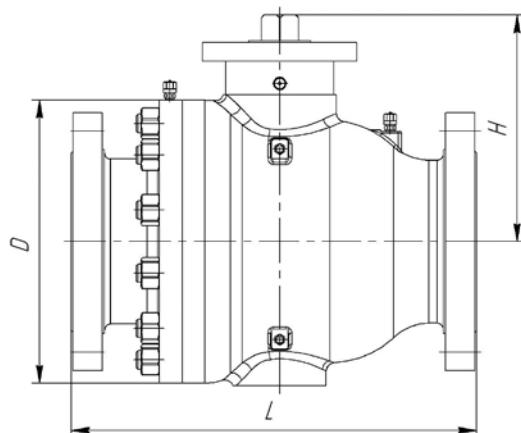
**Рис. 27. Габаритные и присоединительные размеры кранов шаровых РУСТ® серии 600**
