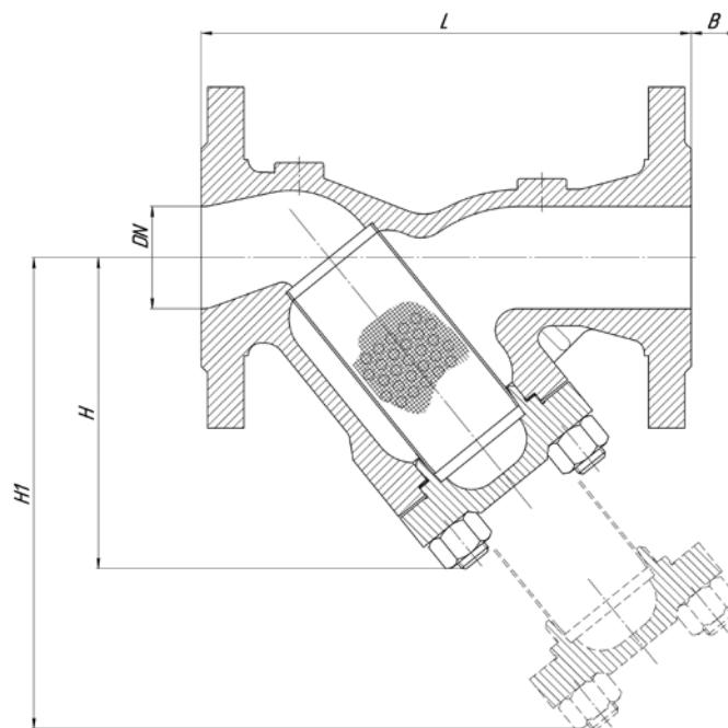
**Рис. 51. Габаритные и присоединительные размеры фильтров сетчатых Y-образного типа серии ФС**
