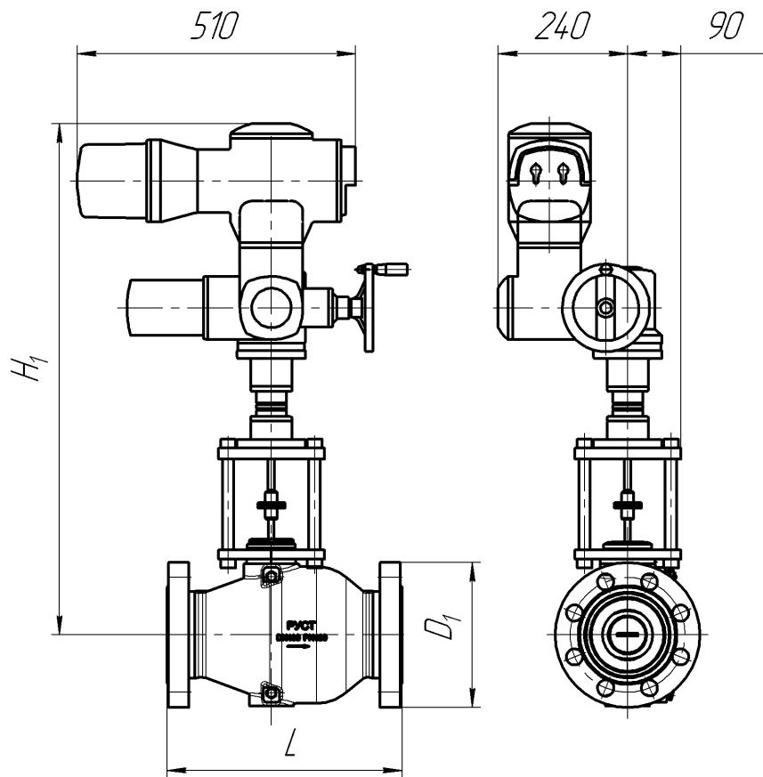
**Рис. 41. Габаритные и присоединительные размеры клапанов осевых РУСТ® серии 900 с электроприводом AUMA**
