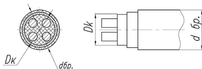
Рис.68 Dk – диаметр уплотняемого кабеля;
